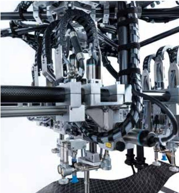
„Anders als z. B. die Pneumatik ermöglicht die Servotechnik, verschiedene Linearpositionen ohne mechanisches Umrüsten flexibel anzufahren. Das war für den Prozess entscheidend.“
